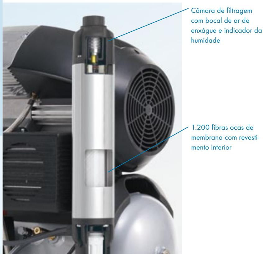
Após um longo período de funcionamento do compressor, a humidade no secador de adsorção aumenta. O secador de membrana, pelo contrário, mantém-se seco e não necessita de interrupções para a regeneração.
